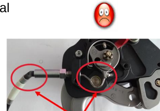
Broken or kinked conduit
